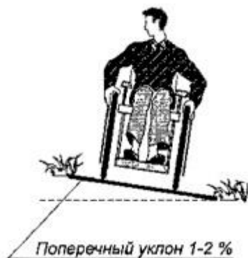
Рисунок 4 – Максимально допустимое значения поперечного уклона
