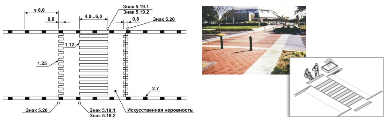
Рисунок 30. – Примеры проектных решений наземных нерегулируемых пешеходных переходов, приподнятых над поверхностью проезжей части автомобильной дороги
