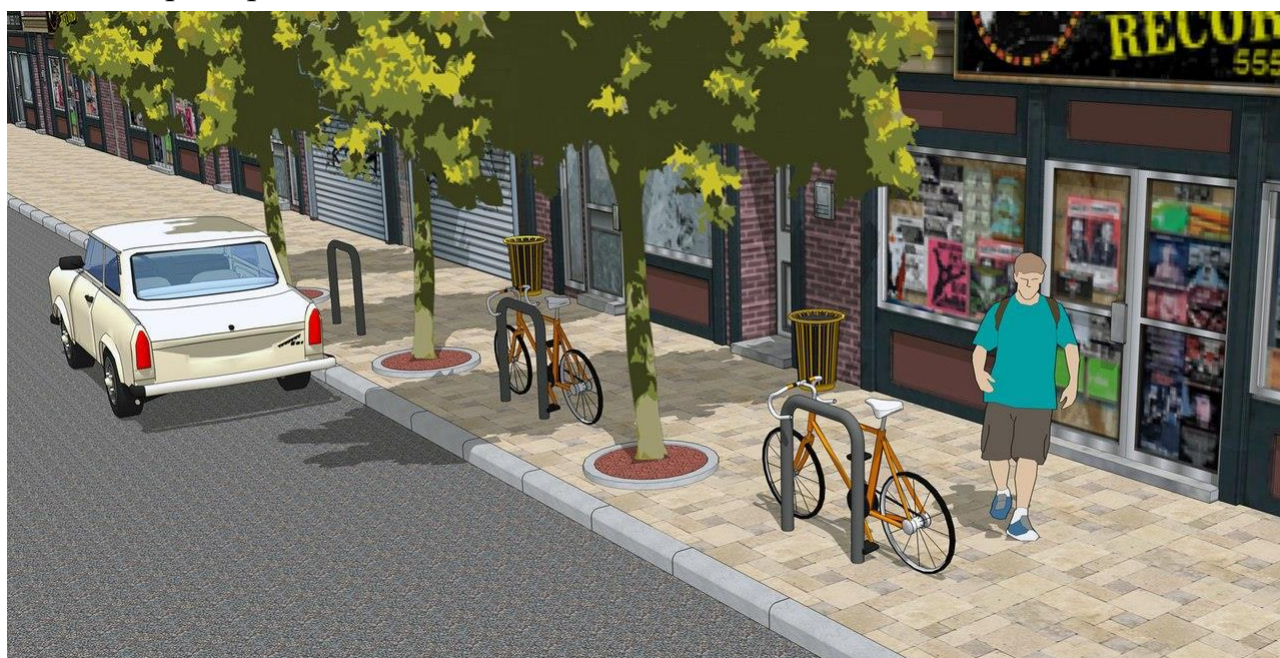
Рисунок 7. Устройство велопарковок в стесненных условиях.
