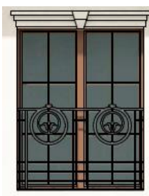
Окно с вертикальным импостом с закрепленными шпросами внутри стеклопакета.
