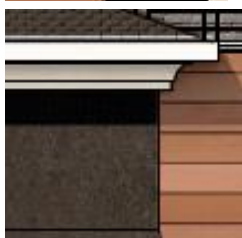
Межэтажный трехступенчатый карниз
