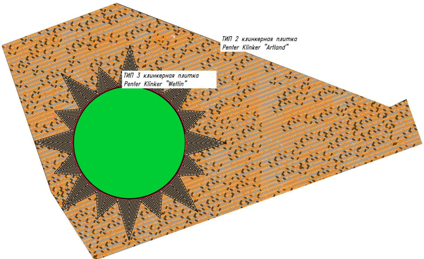
Схема укладки плитки на границе велосипедной дорожки ТИП 3 и пешеходной зоны ТИП 2.
