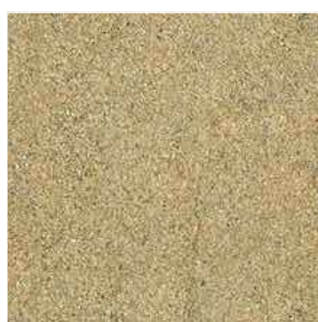
ТИП 3. Утрамбованный щебень горно-перерабатывающего предприятия ООО "Гранитная гора"; фракция 5-20.
