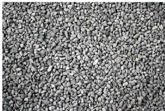
ТИП 3. Утрамбованный щебень горно-перерабатывающего предприятия ООО "Гранитная гора"; фракция 5-20.
