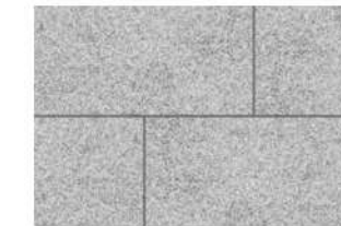
П1 БЕТОННАЯ ПЛИТКА (1000 X 500 X 80 MM)
