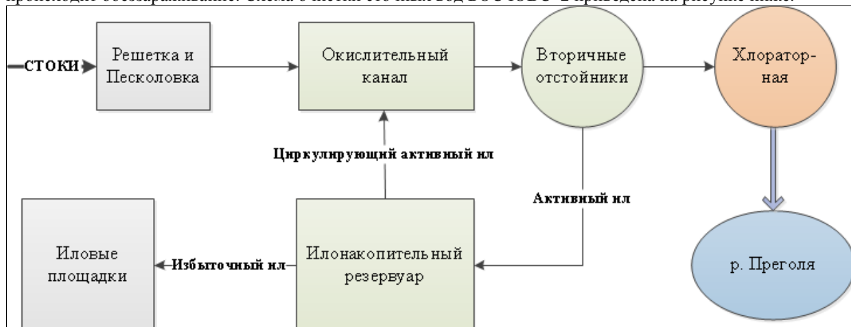
Рисунок 9 Схема очистки сточных вод на БОС ЮВС-2 мкр. Малое Борисово
