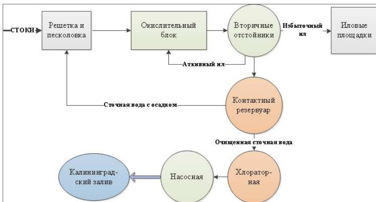
Рисунок 8 Схема очистки сточных вод на ОСК мкр. Прибрежный
