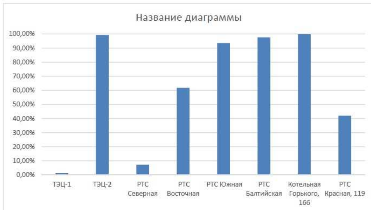
Рисунок 1 – Вероятность безотказной работы трубопроводов крупных источников теплоснабжения
