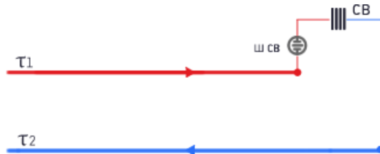
Рис. 2.2.24. Схема №25. Потребитель с вентиляционной нагрузкой
