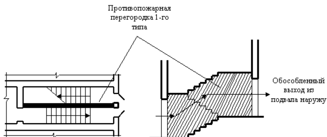
Рис. 7. Выход из подвала предусмотрен через общую лестничную клетку с обособленным выходом наружу, отделенным от остальной части лестничной клетки противопожарной перегородкой 1-го типа.
