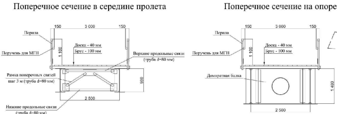
поперечные разрезы моста. масштаб 1:100
