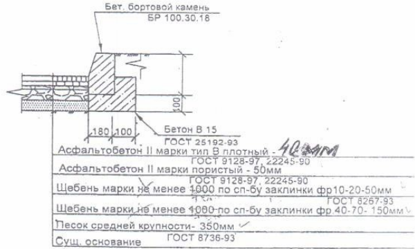
Устройство проезжей части из асфальтобетона
