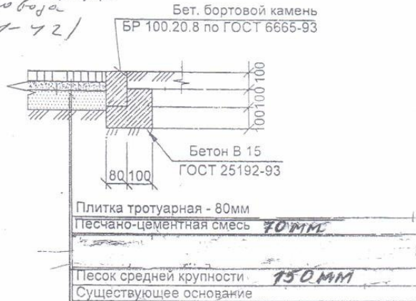
Устройство плиточного покрытия на тротуаре
